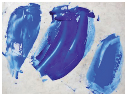
Ил. 1. (Слева) пигмент в льняном масле, (по центру) яичная эмульсия с льняным маслом, (справа) яичная эмульсия
